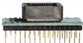
PLCC32 - DIP32 Для процессоров и памяти в корпусе PLCC32
